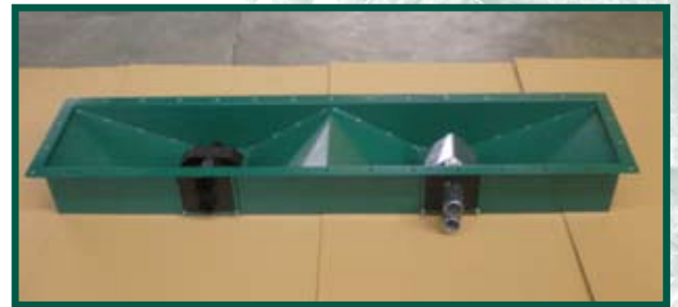
Troguni mit zwei eingebauten Saugsonden → Saugsonden nicht im Lieferumfang enthalten!
